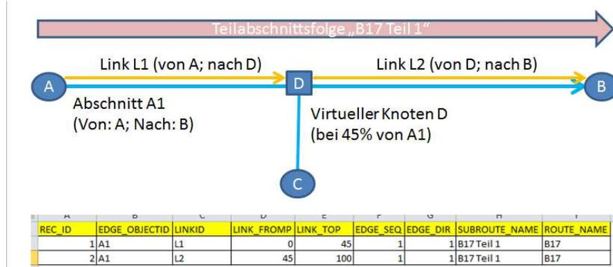
**Teilabschnittsfolge verläuft gegen Richtung über Abschnitt mit 2 Links:**
