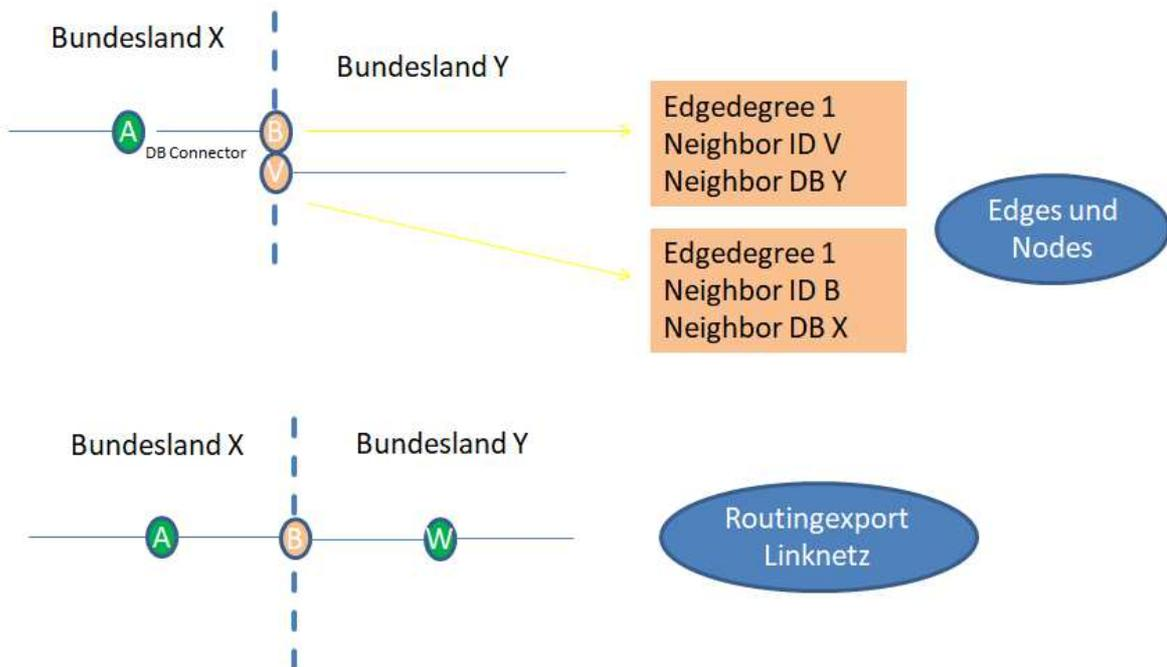
Ab GIP 06/21 werden „Linkknoten“ mitexportiert. Dies sind Knoten mit dem TOPOTYPE 3. Diese sind nur für das LINKNETZ (routingfähig), nicht aber das EDGE Netz relevant.
